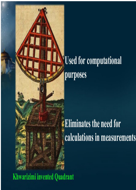
Figura 2. Quadrant – i, instrument i përdorur për përcaktimin e kohës, si dhe kohëve të namazit.
